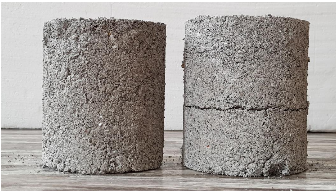
Obr. 14 Objemové změny vzorků ze škváry z řízeného prostředí zralé v laboratorním (vlevo) a v řízeném (vpravo) prostředí
