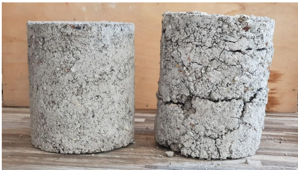
Obr. 13 Objemové změny vzorků z čerstvé škváry zralé v laboratorním (vlevo) a v řízeném (vpravo) prostředí
