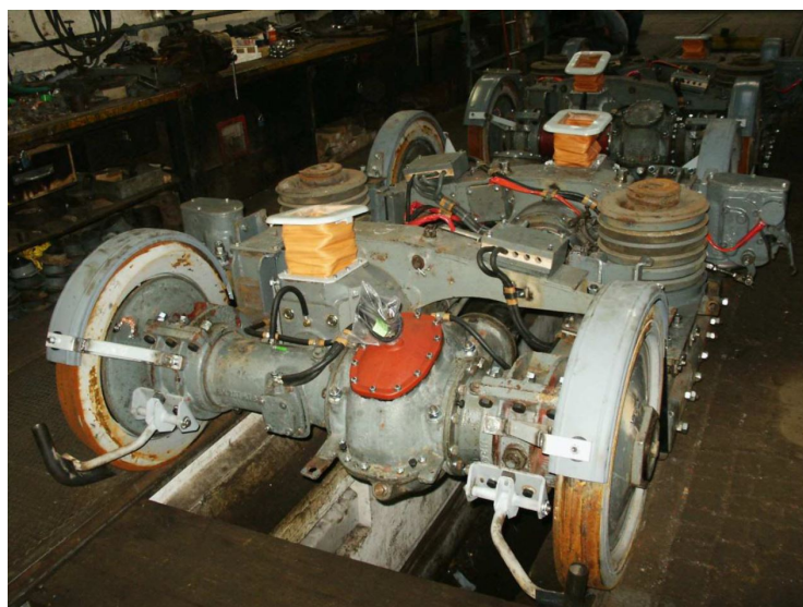
Obrázek 1.1: Podvozek tramvajového vozu Tatra T3 [3]
