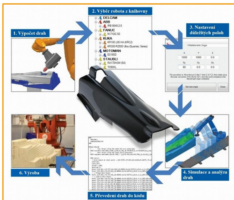
Obr. 3.19 Průběh CAD/CAM programování [6]
