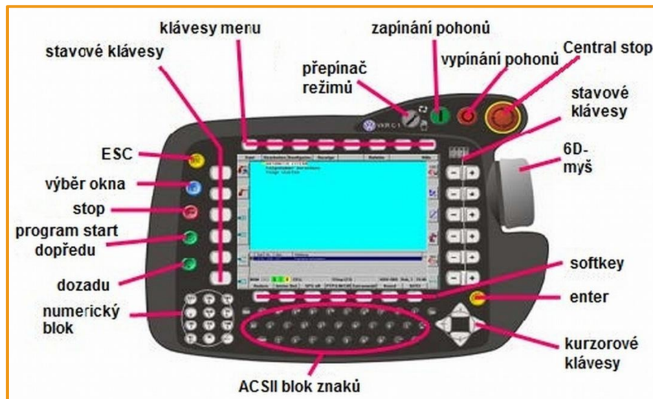
Obr. 3.6 Jednotlivá funkční tlačítka teach-pendantu [3]
