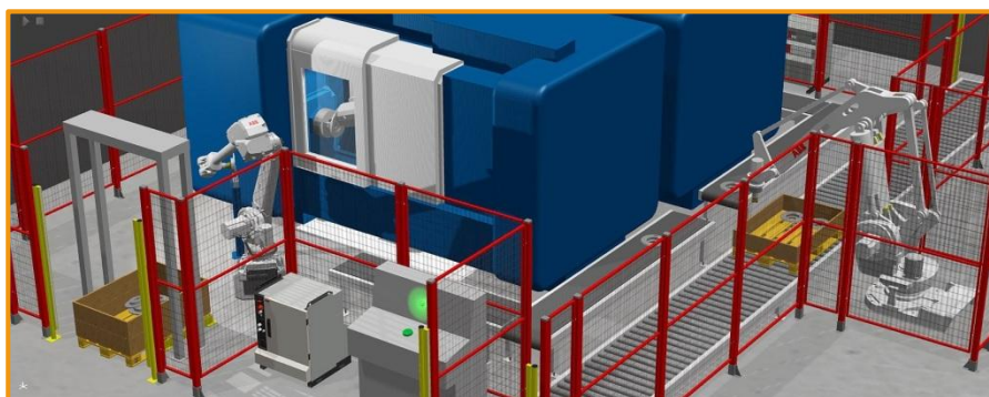
Obr. 3.10 Virtuální model pracoviště v programu RobotStudio [1]
