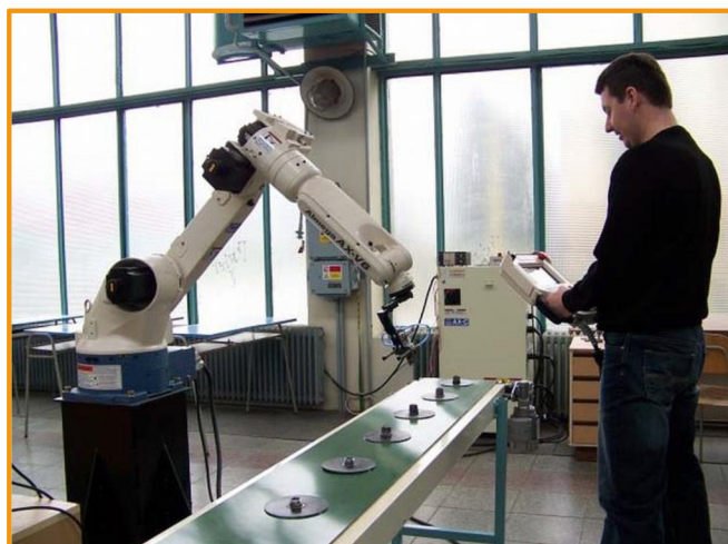
Obr. 3.5 Programování pomocí teach-pendantu [3]
