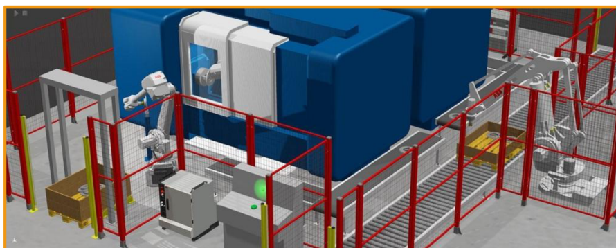
Obr. 3.10 Virtuální model pracoviště v programu RobotStudio [1]
