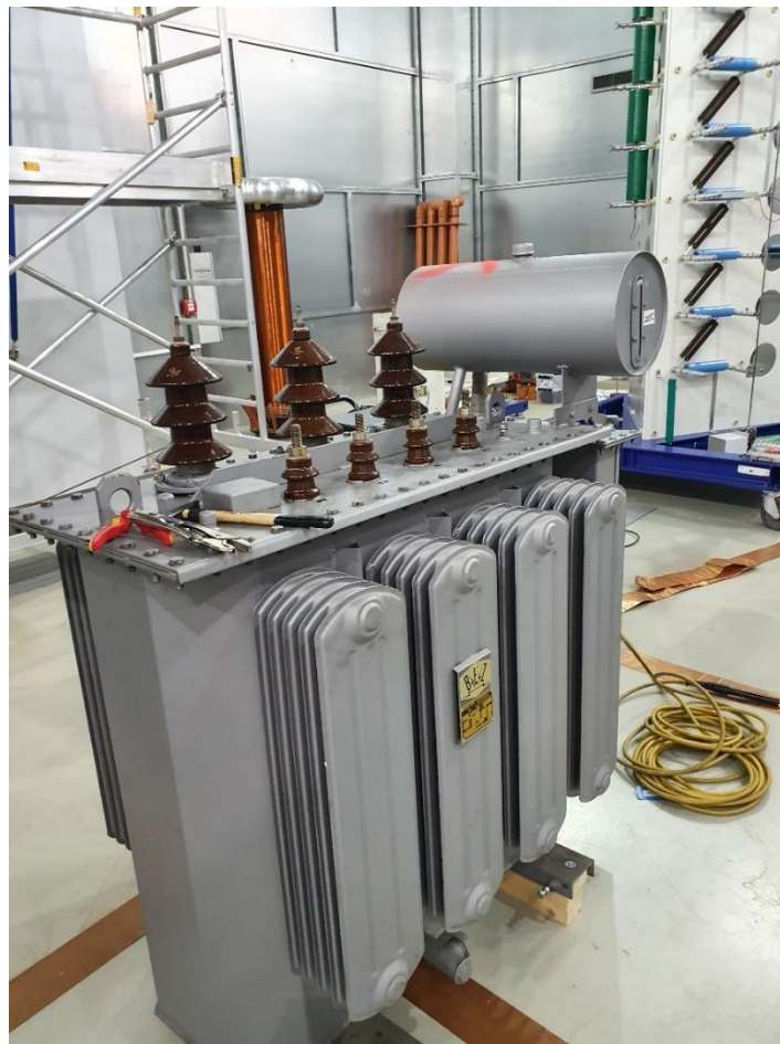
Obr. 3-1 Skúšaný distribučný transformátor
