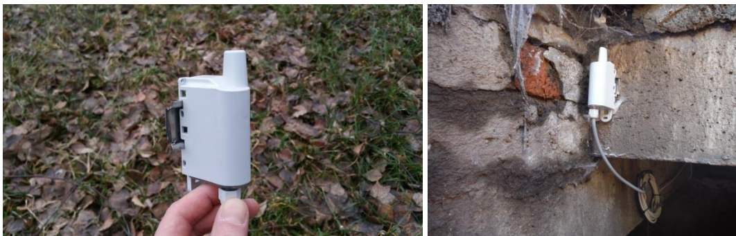
Obrázek 25 a 26: Vysílač LoRa – obrázek vlevo; umístění vysílače zařízení LoRa v OK č. 23, Dalovice, Hlavní ul. x Všeborovická ul., u masny – obrázek vpravo.
