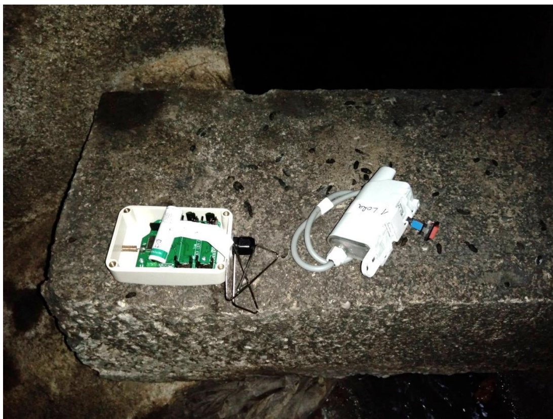
Obrázek 14: Vlevo zkušební zařízení SigFox a vpravo LoRa.
