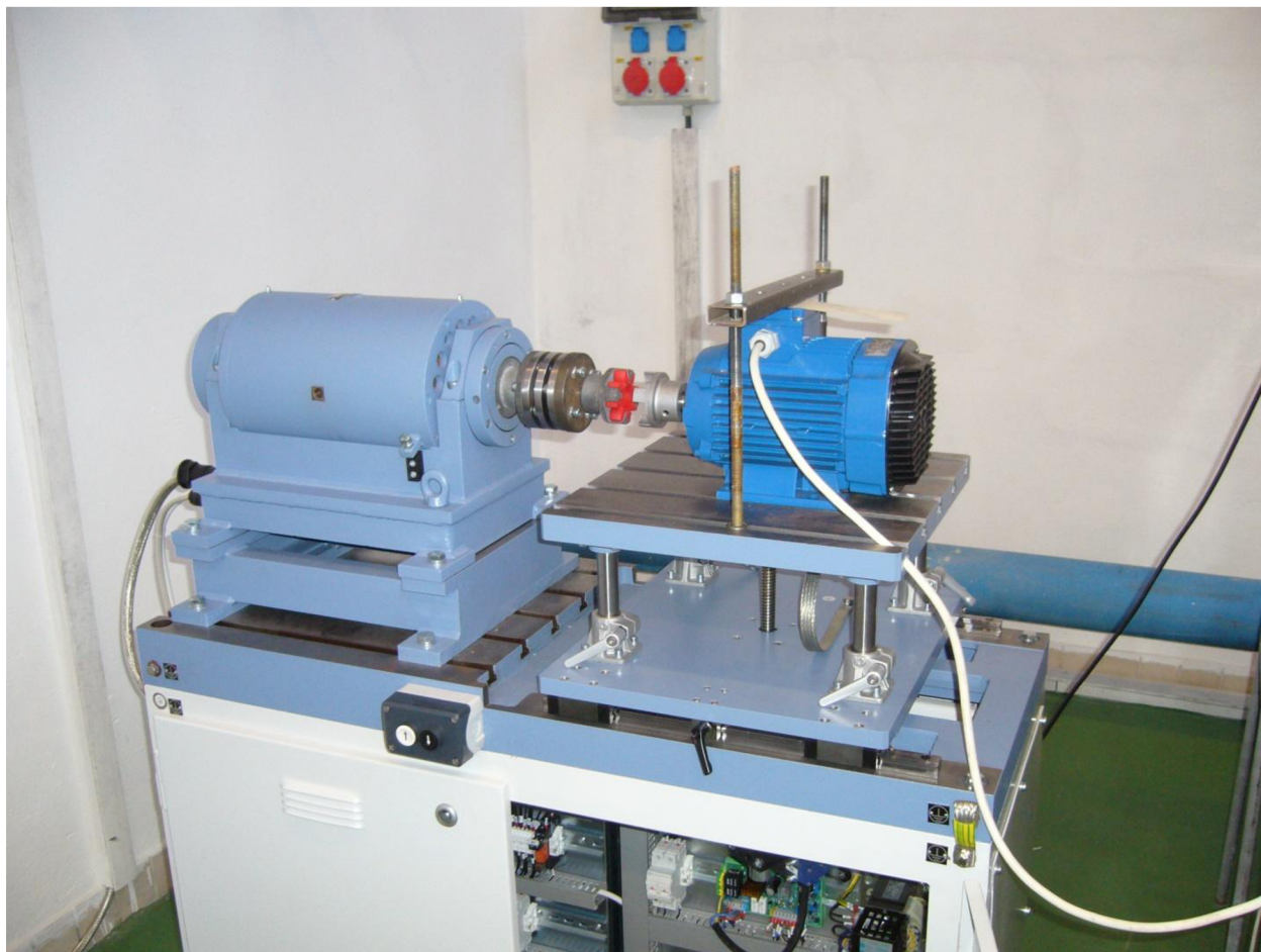
Obrázek 4 Motor TM90-4S a dynamometr
