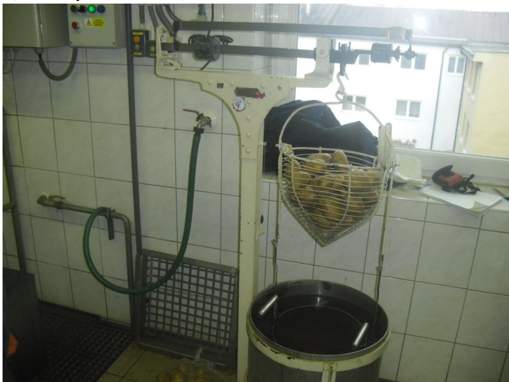
Obrázek 18 – Měření obsahu škrobu pomocí Hošpes-Pelcoldovy váhy (Škrobárny Pelhřimov a.s.)
