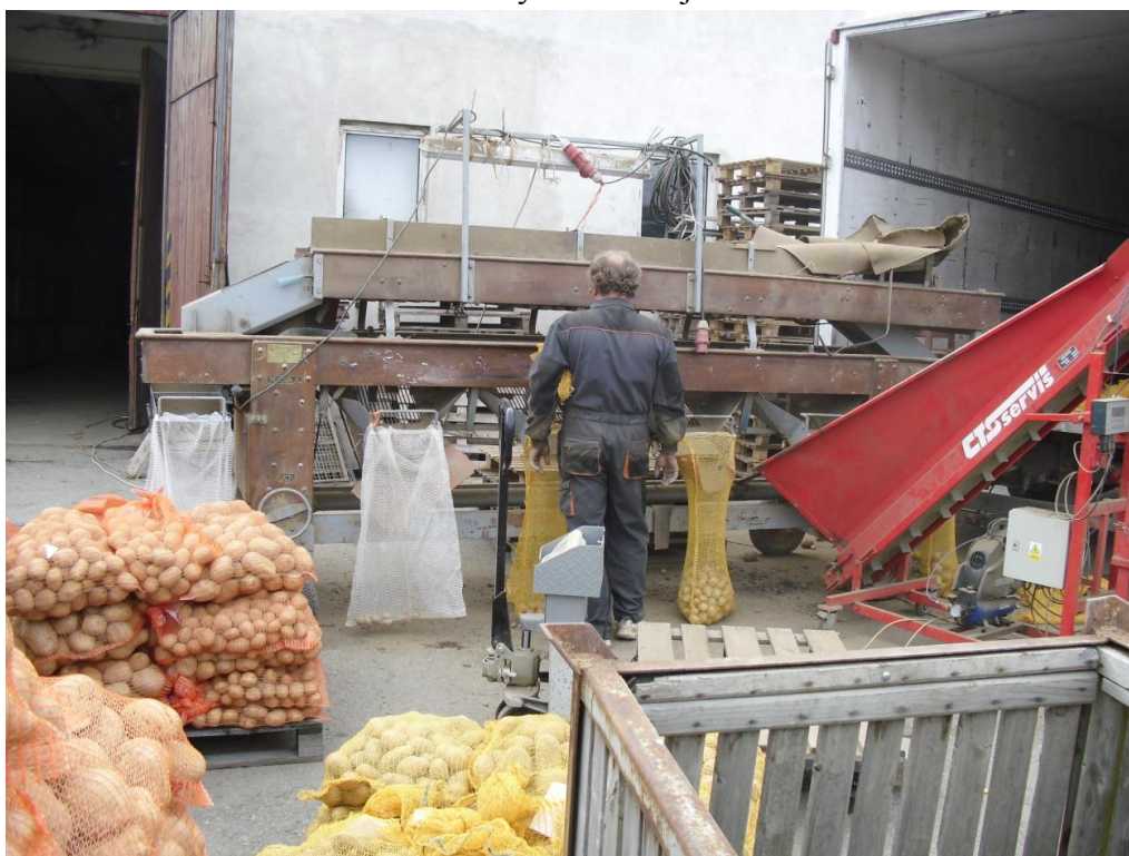
Obrázek 17 – Roztřídění sklizených hlíz na jednotlivé velikostní frakce.
