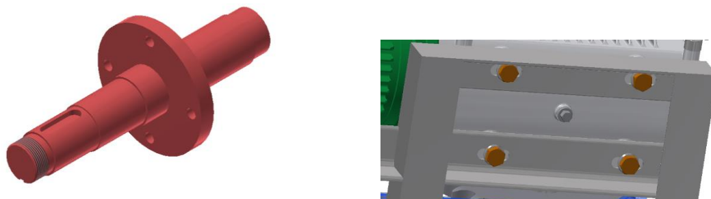
Obr. 21: Výstupní hřídel a mechanismus napínání řetězu
