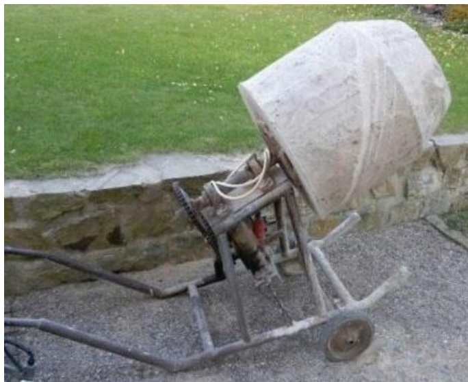
Obr. 6: Hřidel poháněný pomocí řetězu (upraveno dle (10)).
