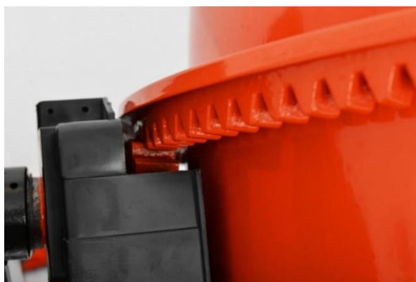
Obr. 4: Pastorek a ozubený věnec na obvodu bubnu (upraveno dle (8)).
