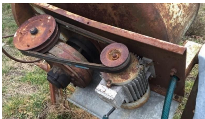
Obr. 7: Hřidel poháněný pomocí řemenu (upraveno dle (11)).
