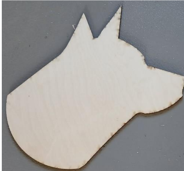
Obr. 23 Šablona zhotovena za pomoci laseru
