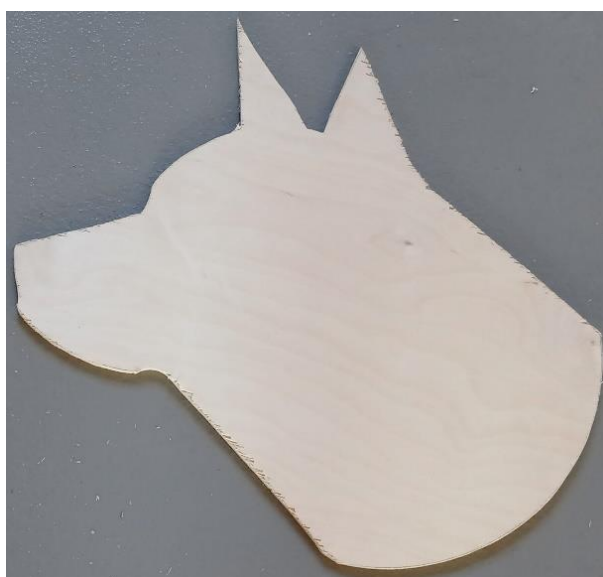
Obr. 24 Šablona zhotovena za pomoci přímočaré pily
