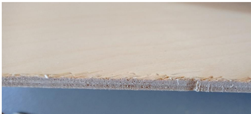
Obr. 22 Odštěpená vlákna řezáním
