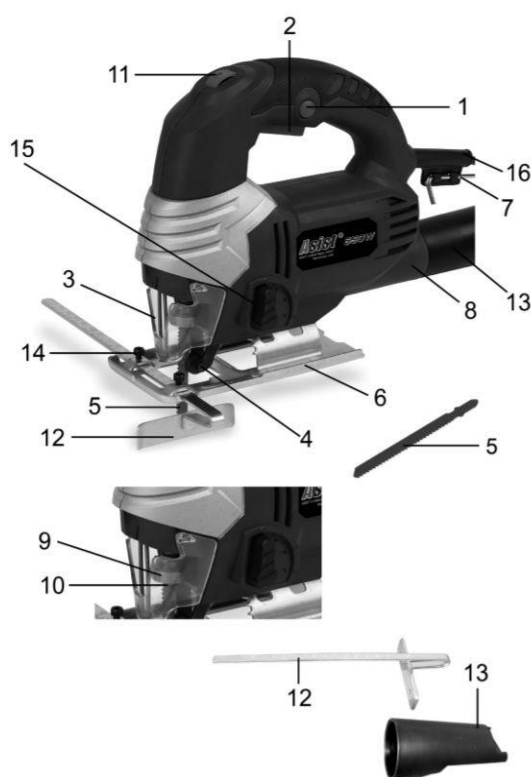
Obr. 11 Popis základní konstrukce přímočaré pily
