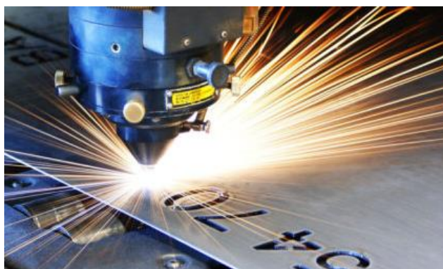
Obr. 7 Kovový výrobek vytvořený laserovým řezáním
