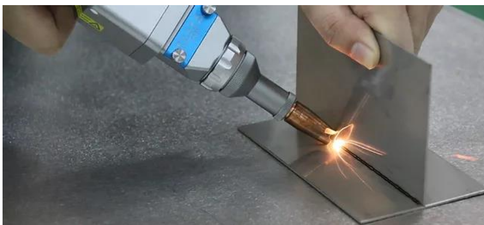
Obr. 10 svařování kovového materiálu laserovým paprskem
