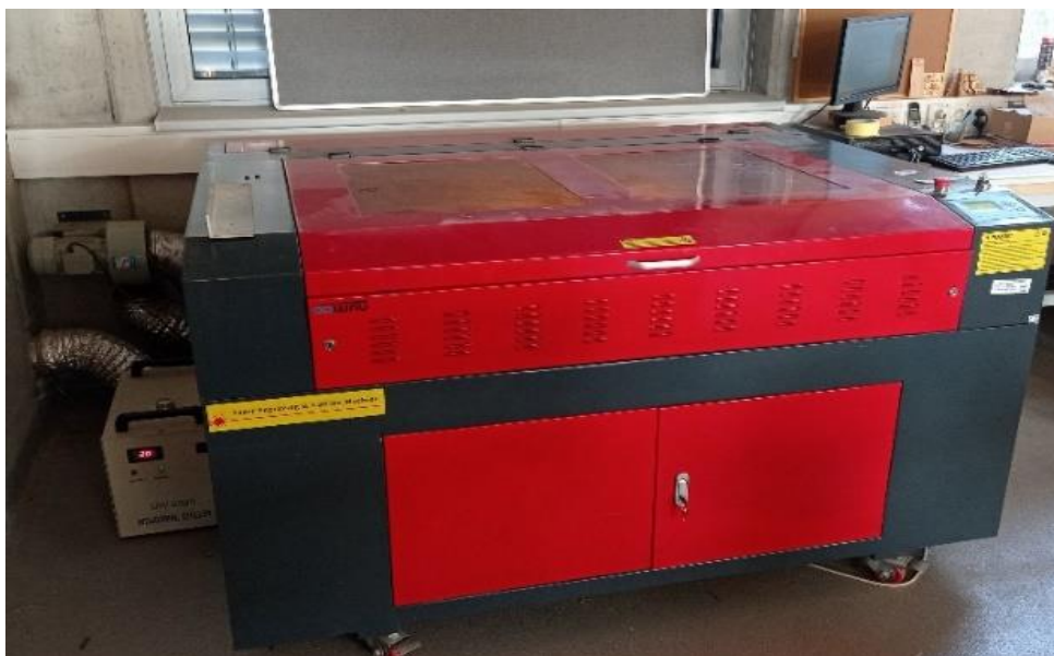
Obr. 14 Gravírovací a řezací CO 2 laser Numco C 1290
