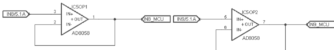
Obrázek 2.13 Zapojení přímých UART vstupů
