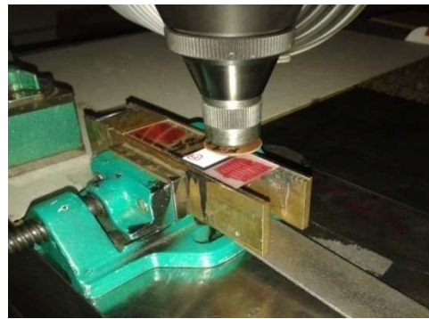
Obr. 22: Uchycení sklíček (převzato z cit. 96 )
