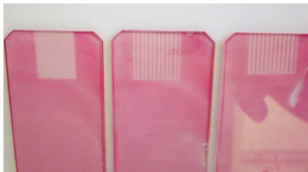
Obr. 23: Hladké sklíčko po ablaci laserem
