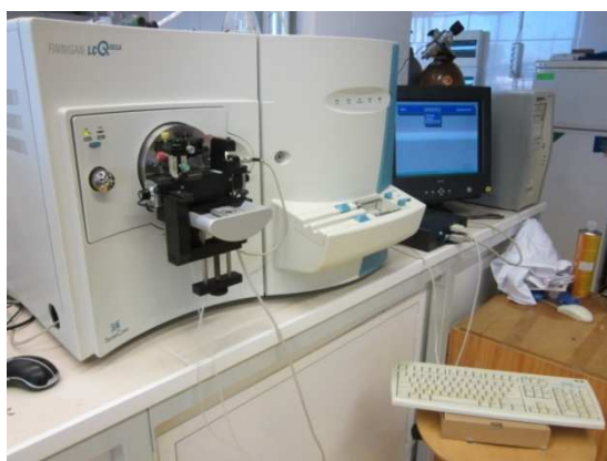
Obr. 16: Desorpční nanoelektrosprej vyvinutý na Katedře analytické chemie Univerzity Palackého v Olomouci spojený s hmotnostním spektrometrem LCQ DECA (Thermo Finnigan, USA)
