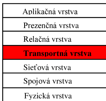
Obr. 3.1 Tranportná vrstva v modeli ISO/OSI
