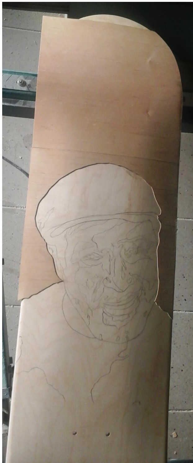
Obrázek 36: Nalepení dýhy na prkno
