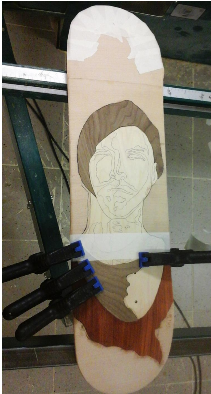
Obrázek 37: Uchycení páskou a truhlářskými svěrkami
