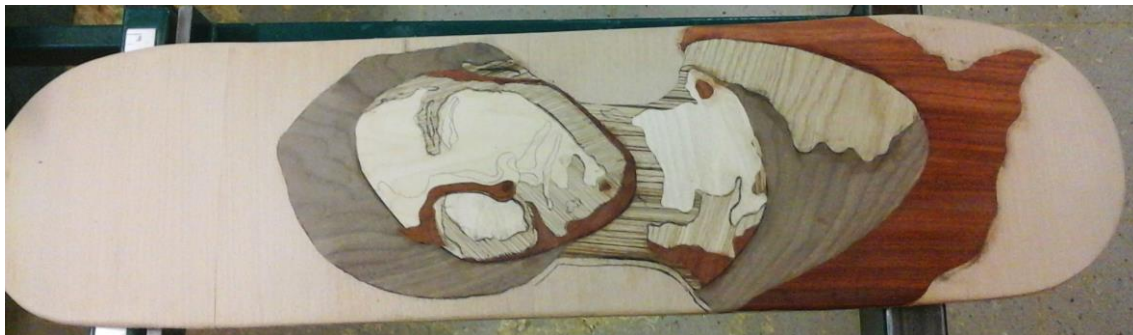
Obrázek 38: Lepení intarzie směrem do středu
