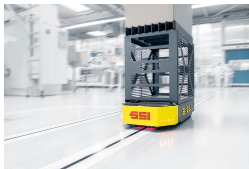
Obr. 2 Příklad vyznačení dráhy pomocí magnetického pásku [32]
