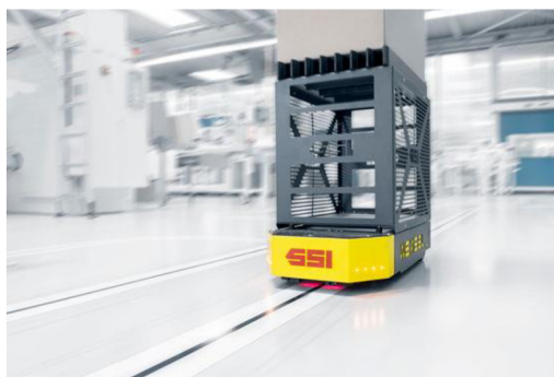
Obr. 2 Příklad vyznačení dráhy pomocí magnetického pásku [32]
