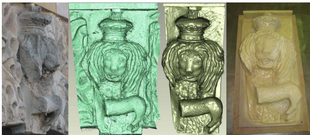
Obr. 16: Skenovaná socha, bodové mračno, 3D model a odlitek z formy vytvořené z 3D modelu (Lichti, 2008)
