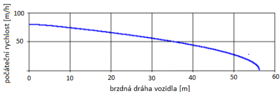
Obrázek 19. Průběh brzdění vozidla při dynamické zkoušce brzdného účinku [3]
