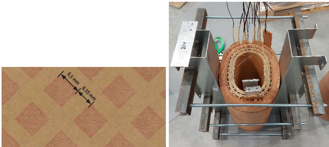
Obrázek 3.12 Zleva a) Izolační papír s pryskyřicí [20] b) Stažené vinutí připravené na vytvrzení v peci
