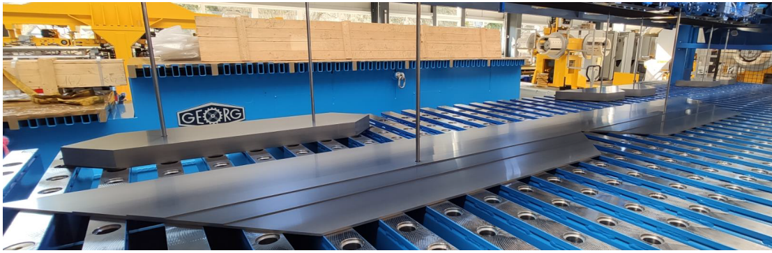
Obrázek 2.16 Stohovací vozík s podélnými a příčnými pozicemi pro stohování plechů [14]
