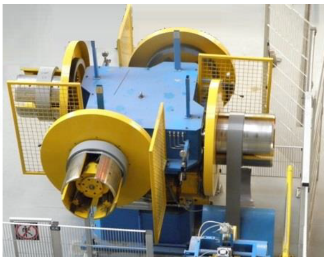
Obrázek 2.9 Odvíjecí zařízení se čtyřmi bubny [14]
