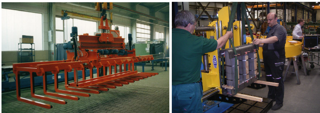
Obrázek 2.17 Zleva a) Hrábě na vyjmutí sloupků ze stohovacího vozíku b) Vykládání hotového jádra ze stolu [14]
