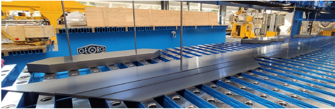
Obrázek 2.16 Stohovací vozík s podélnými a příčnými pozicemi pro stohování plechů [14]
