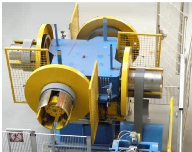
Obrázek 2.9 Odvíjecí zařízení se čtyřmi bubny [14]
