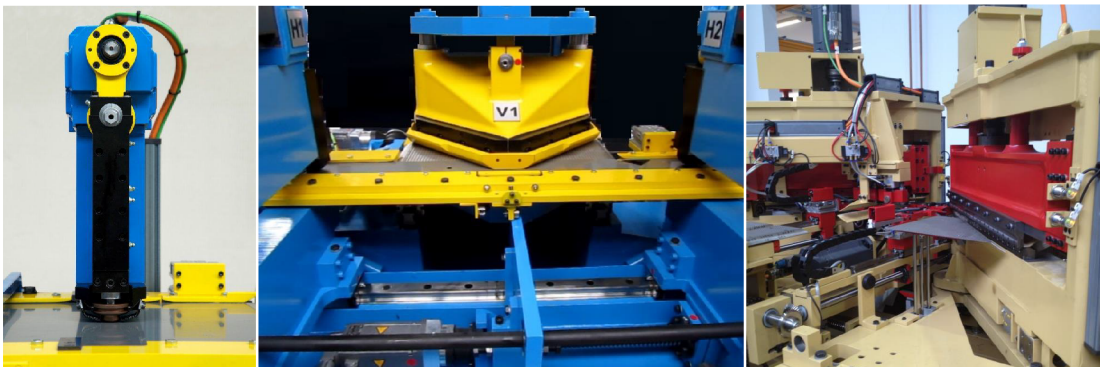
Obrázek 2.11 Zleva a) Děrovací kleště b) Nůžky pro V-výseč c) Nůžky pro oddělení plechu pod úhlem 45^\circ [14]
