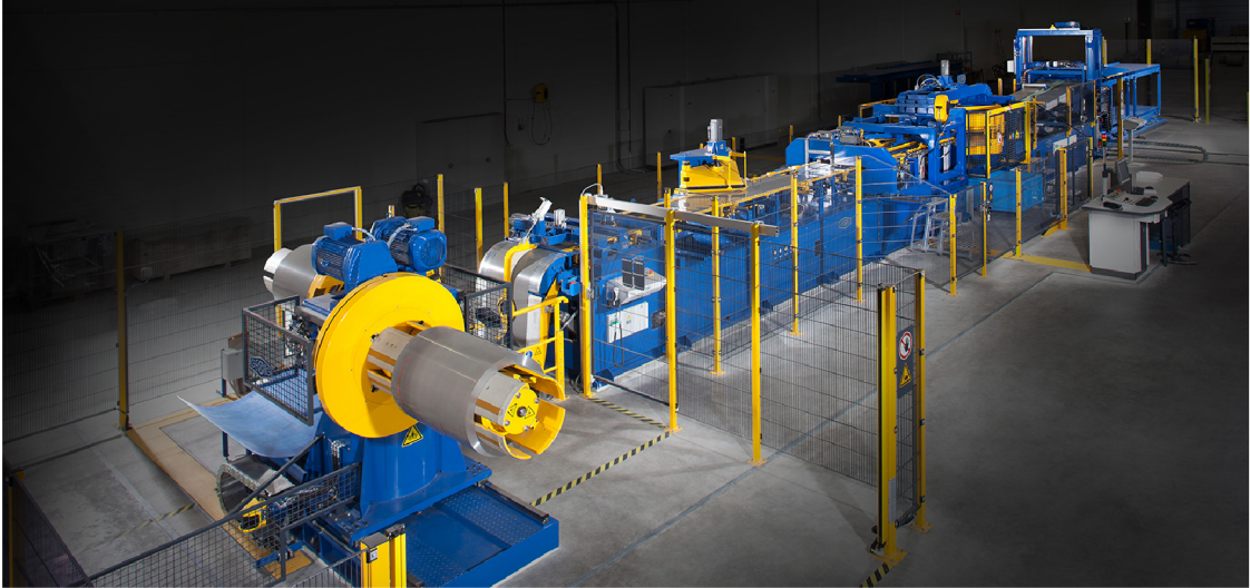
Obrázek 2.8 Celá vysekávací linka Georg precisioncut TBA 400 [14]
