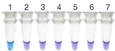
Obrázek 17: Kolorimetrický LAMP. Změna barvy na fialovou značí pozitivní reakci.
