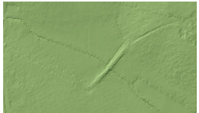
Obr. 90: Zachovalá hráz 15.3. Bezejmenného vodního díla na Analýzách výškopisu. (Dostupné z: https://ags.cuzk.cz/avl/ , navštíveno 25. 6. 2023).
