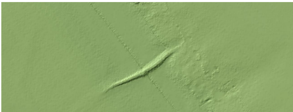
Obr. 8: Zachovalá hráz 1.1. Bezejmenného vodního díla na Analýzách výškopisu. (Dostupné z: https://ags.cuzk.cz/avl/ , navštíveno 18. 6. 2023).
