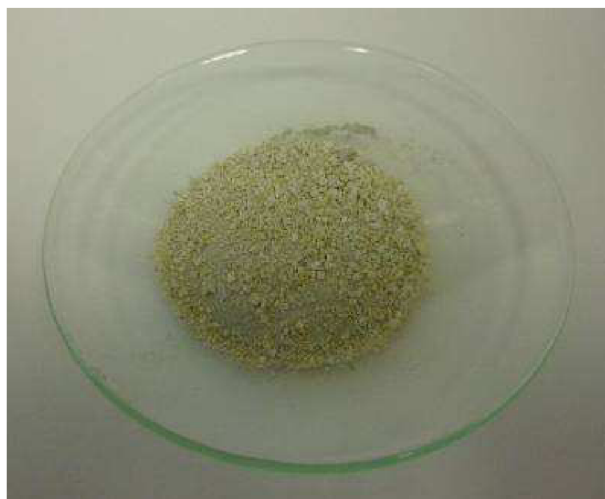
Obrázek č. 8: ZnO připravené rozkladem \text{ZnCO}_3 (Foto: M. Štefka)
