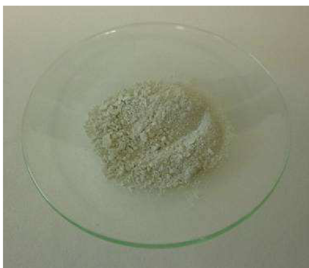
Obrázek č. 9: ZnO připravený reakcí s NaOH po opětovném vyžíhání nad kahanem (Foto: M. Štefka)
