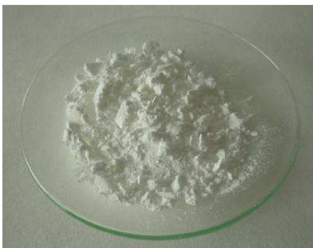
Obrázek č. 7: \text{ZnSO}_4 \cdot 7\text{H}_2\text{O} připravený cementací (Foto: M. Štefka)
