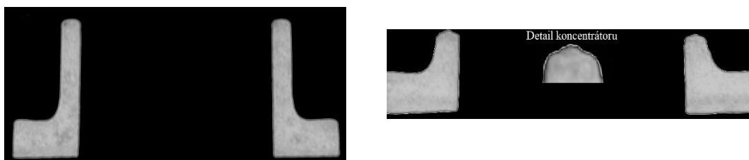
Obr. 3.36 Vlevo vyšší díl a vpravo nižší díl pro PA 12 GB chem. vyhlazený
