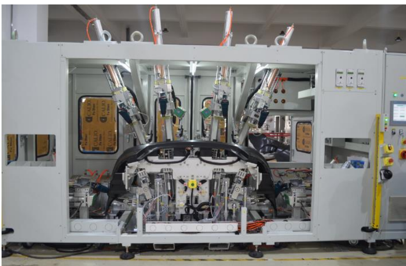
Obr. 2.6 Ultrazvukové svařování předního blatníku [3]
