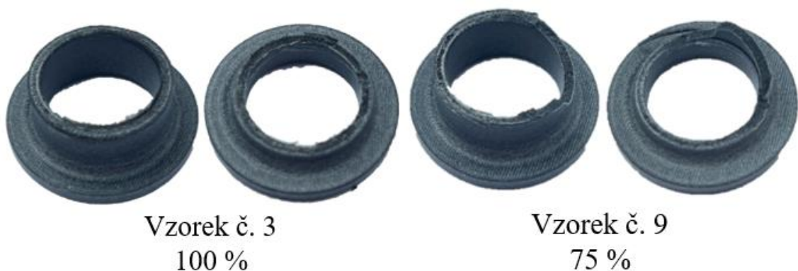
Obr. 3.38 Křehký lom vzorku PA 12 GB – vlevo bez úpravy, vpravo chemicky vyhlazený
