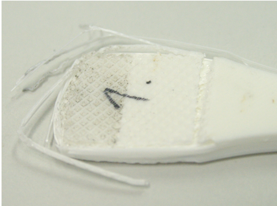
Obrázek 5.3: Těleso číslo 1 rectilinear 100% rozdrcená upínací část
