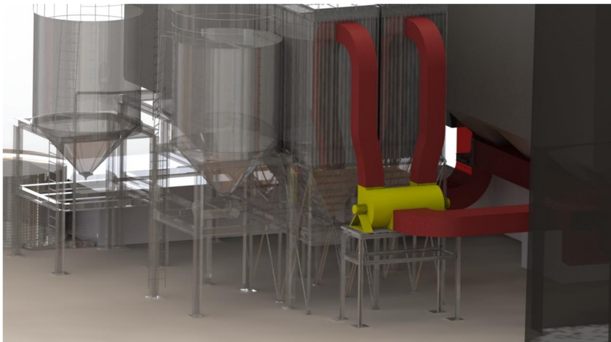
Obrázek 30 Prostorové řešení spalinových ventilátorů (žlutě)
