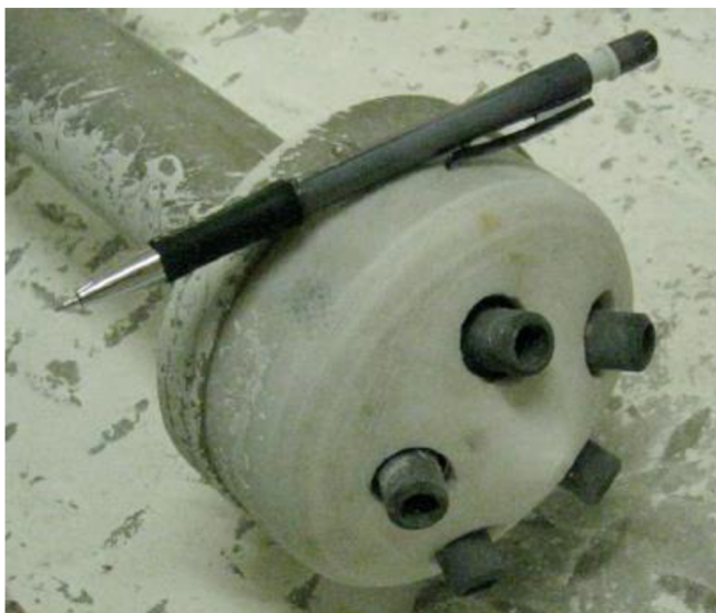
Obrázek 9 Hlava s pěti tryskami k distribuci suspenze [30]
