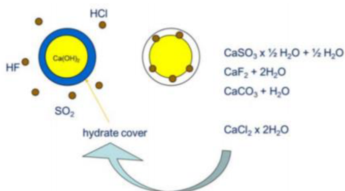
Obrázek 13 Mechanismus hydrátového pláště [44]
