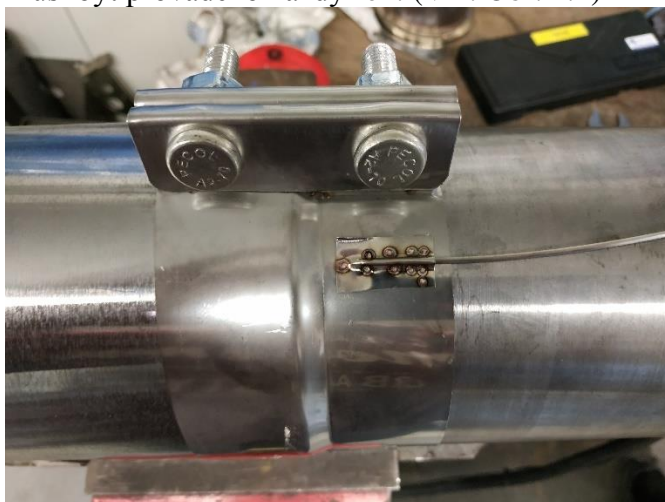
Obr. 2.6 Umístění hlavního termočlánu dle [10]
