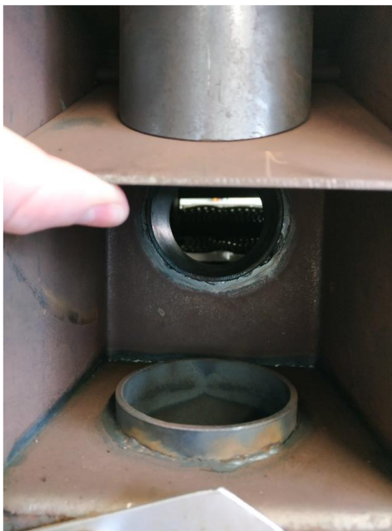
Obr. 5.7 Otevřená klapka chladicího okruhu
