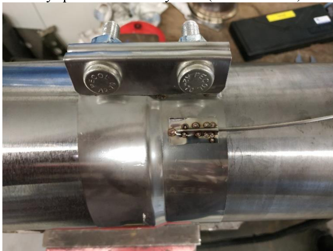
Obr. 2.6 Umístění hlavního termočlátku dle [10]
