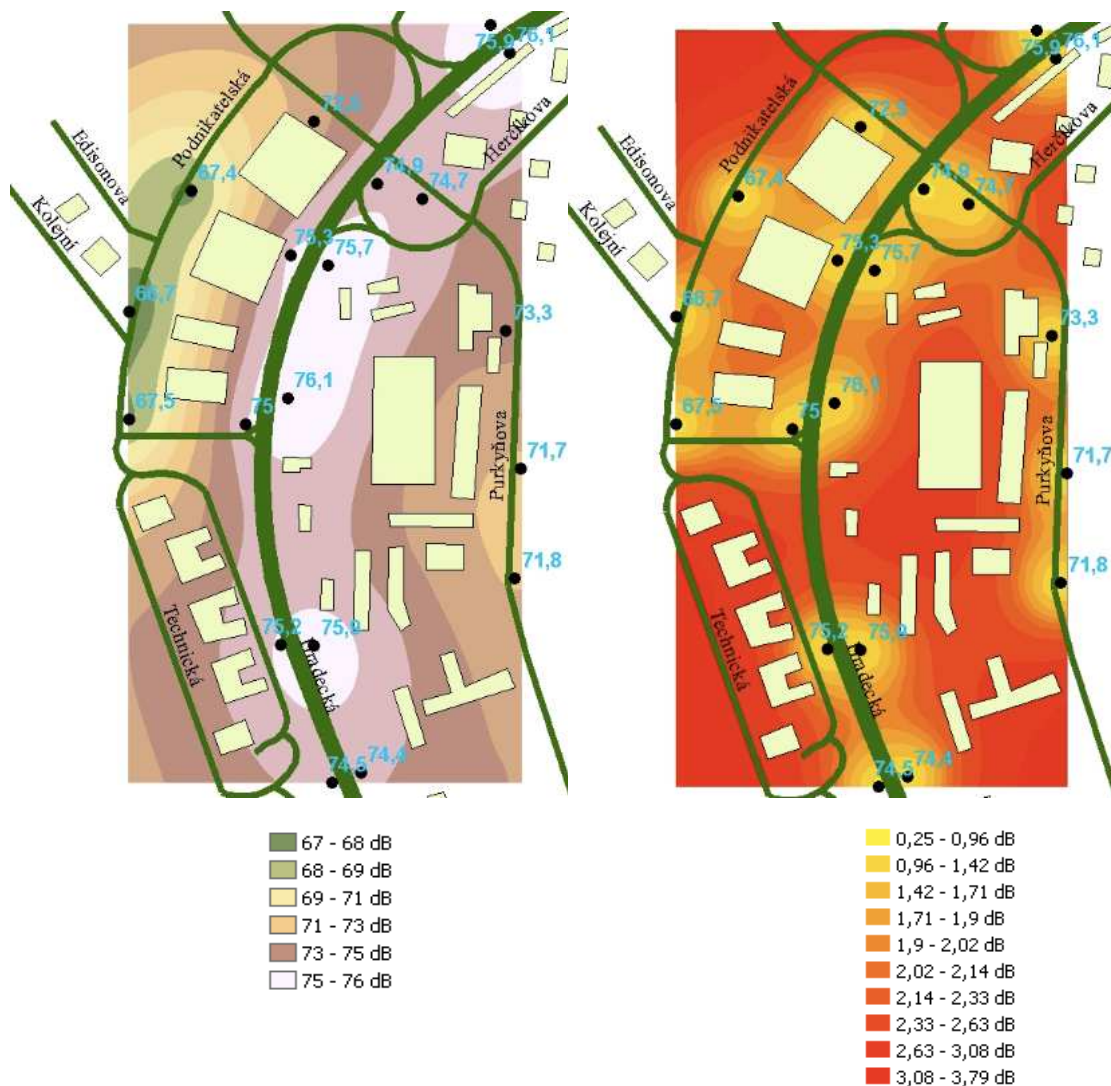
Obr. č. 21 Hluková mapa vytvořená metodou Ordinary Kriging a mapa předpokládaných středních chyb
