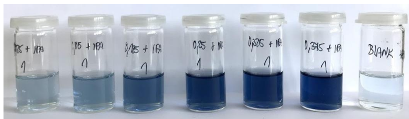
Obr. 22: Koncentrační řada vzorků s albuminem.
