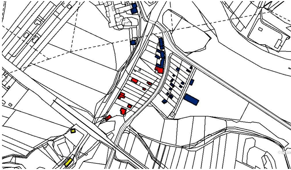
Obr. 49: Zasažené objekty v městysi Katovice při průchodu povodňové vlny Q_5 (žlutě), Q_{20} (červeně + žlutě) a Q_{100} (modře + červeně + žlutě) na podkladu katastrální mapy (autor)
