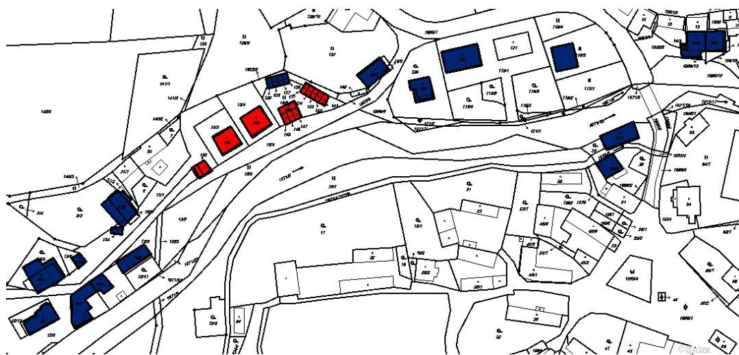
Obr. 43: Zasažené objekty v obci Štěchovice při průchodu povodňové vlny Q_{20} (červeně) a Q_{100} (modře + červeně) na podkladu katastrální mapy (autor)
