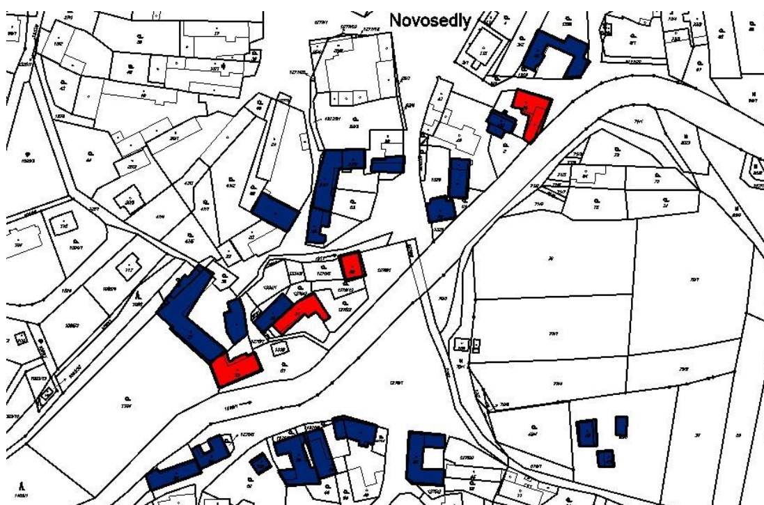
Obr. 46: Zasažené objekty v obci Štěchovice při průchodu povodňové vlny Q_{20} (červeně) a Q_{100} (modře + červeně) na podkladu katastrální mapy (autor)
