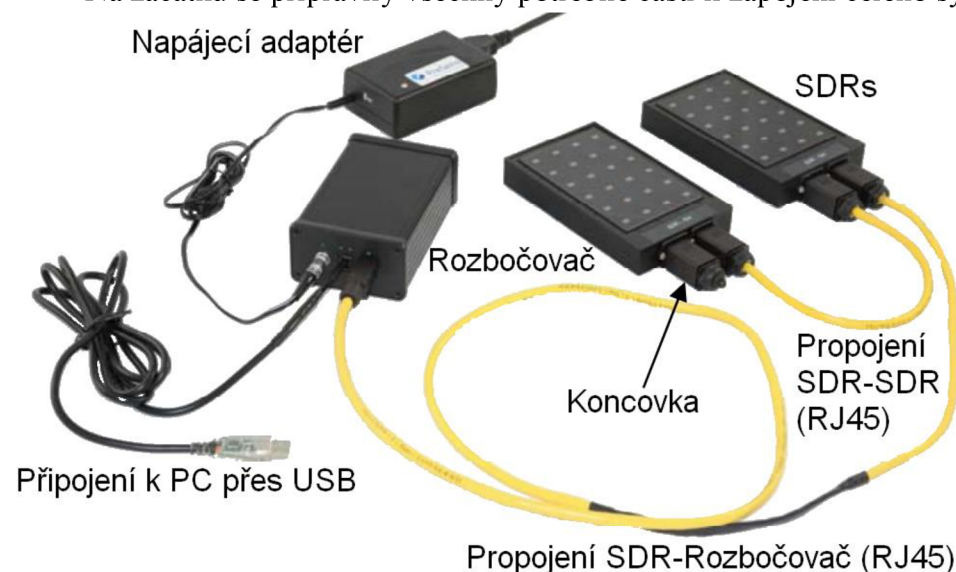
Obr. 7 Propojení jednotlivých částí mikrorespirometru. Upraveno podle (Presens Precision Sensing 2016).
