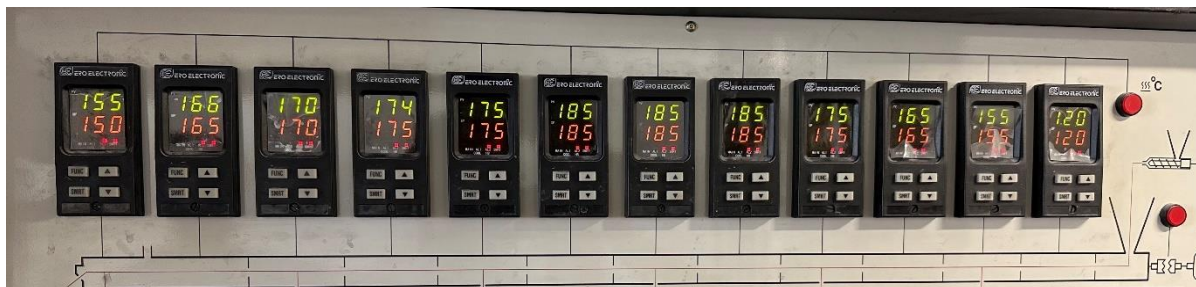
Obr. 14: Zpracovatelské podmínky dvoušnekového extrudéru při přípravě masterbatchů
