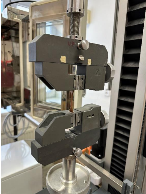
Obr. 20: Uchycení vzorku do čelistí při tahové zkoušce
