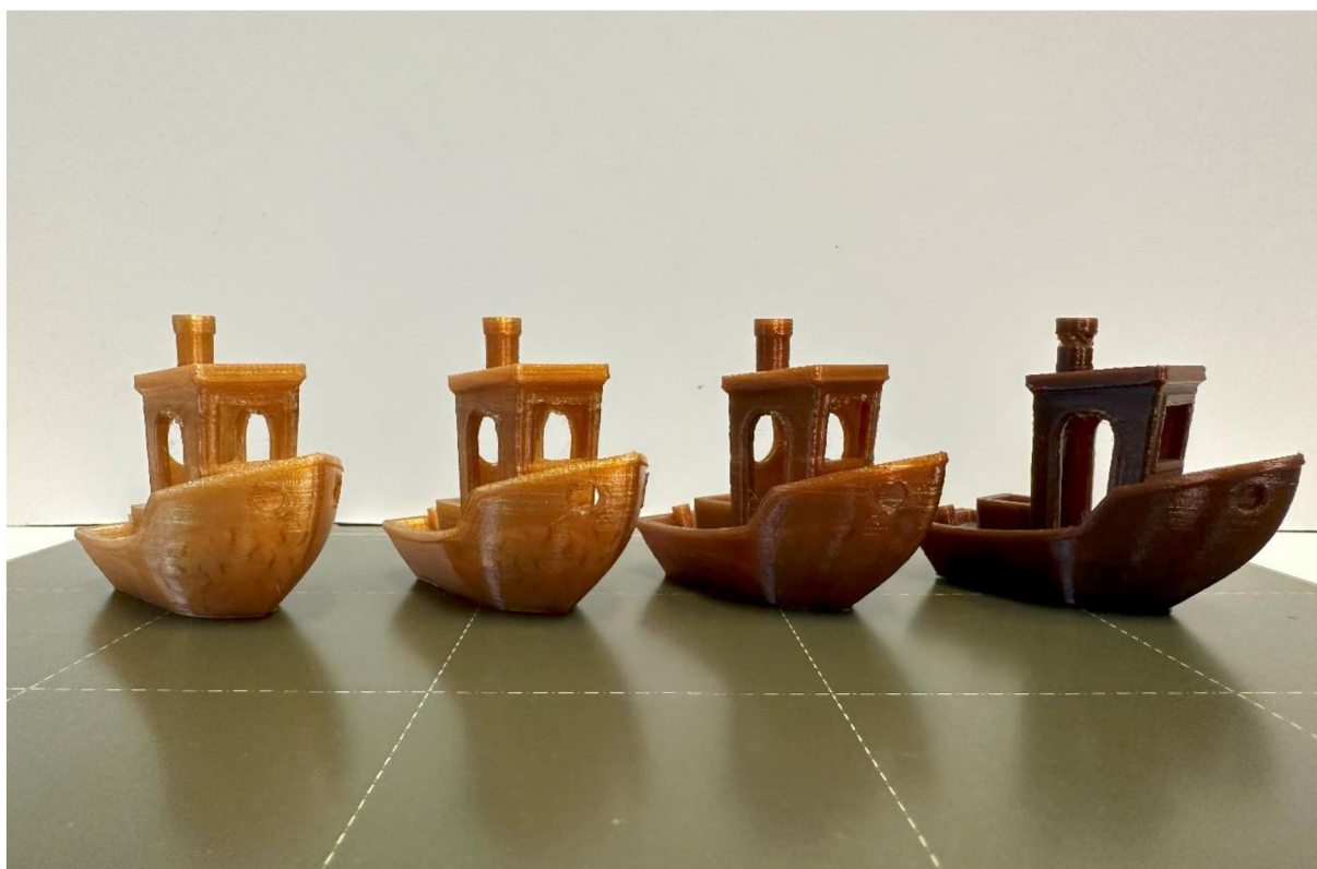
Obr. 33: Koncentrační řada bio-barviva Blauholzextrakt zleva 0,25 %; 0,5 %; 1 % a 2 %
