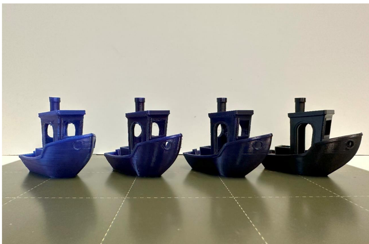
Obr. 35: Koncentrační řada bio-barviva Indigo Echt zleva 0,1 %; 0,25 %; 0,5 % a 2 %
