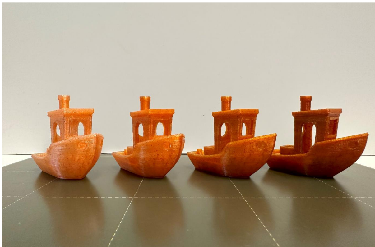
Obr. 39: Koncentrační řada bio-barviva Santalové dřevo zleva 0,25 %; 0,5 %; 1 % a 2 %
