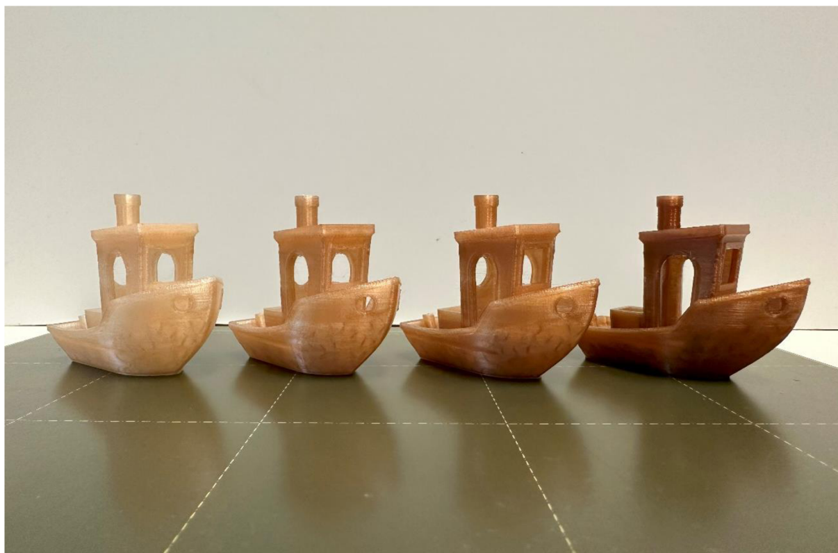
Obr. 34: Koncentrační řada bio-barviva Catechu zleva 0,25 %; 0,5 %; 1 % a 2 %
