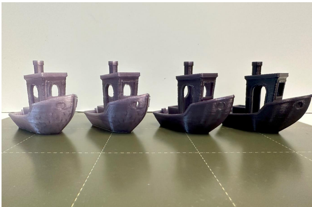
Obr. 38: Koncentrační řada bio-barviva Maya Blau zleva 0,25 %; 0,5 %; 1 % a 2 %
