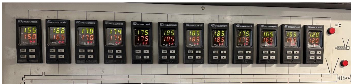
Obr. 14: Zpracovatelské podmínky dvoušnekového extrudéru při přípravě masterbatchů
