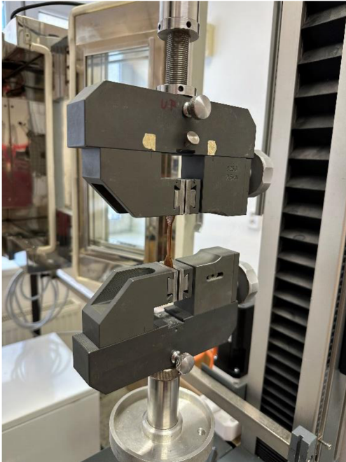
Obr. 20: Uchycení vzorku do čelistí při tahové zkoušce
