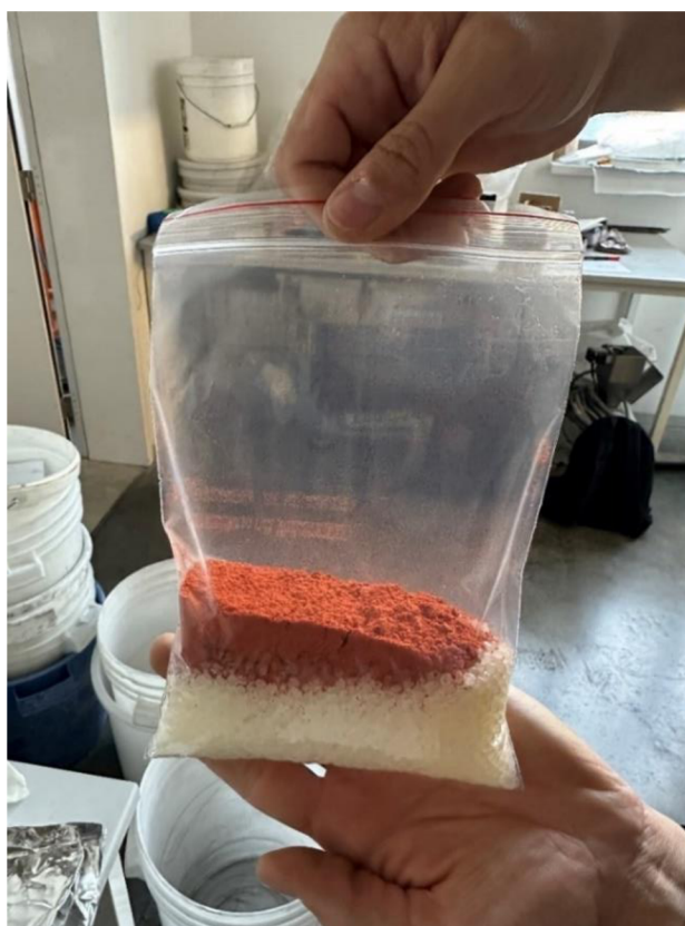
Obr. 13: Příprava navážky masterbache o 5% hmotnostní koncentraci bio-barviva v PLA
