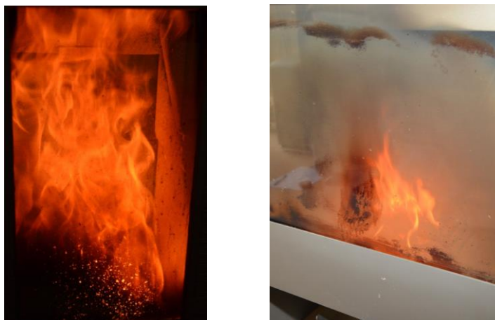
Obr. 5.16: Stopy nedokonalého spalování, komerční brikety z pilin a kompostu
