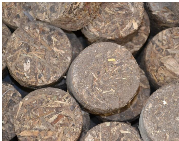
Obr. 4.5: BrikStar EK 20, brikety z kompostu
