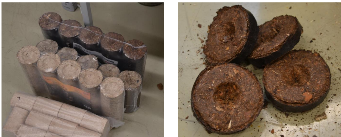
Obr. 4.4: Vzorky komerčních briket, brikety z kůry
