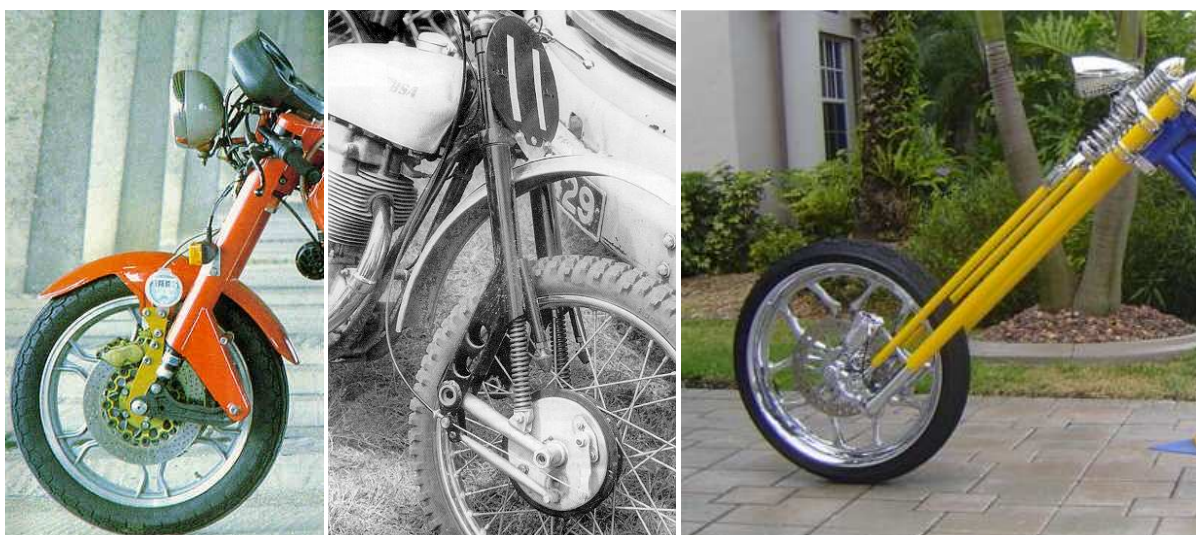
Obrázek 16: Příklady předního zavěšení s tlačným ramenem [18], [19]. [20]
