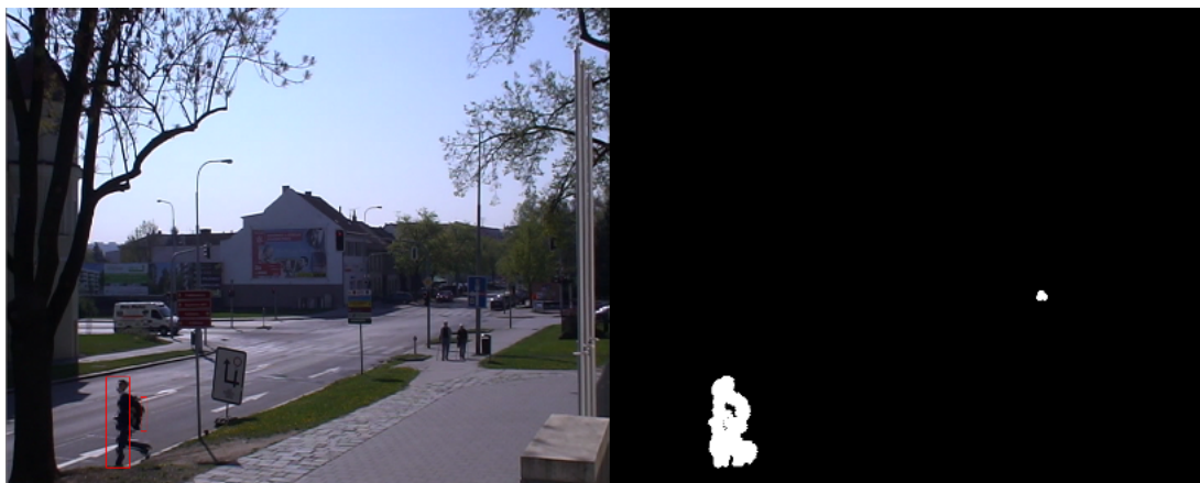
Obrázek 6.4: Díra v objektu.
