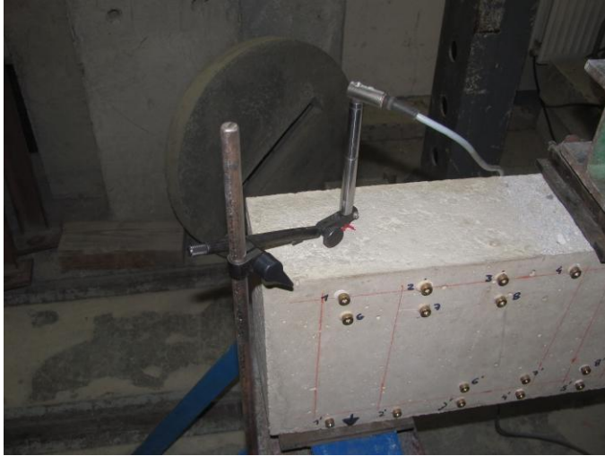
Obr. 1.18. Osazení indukčních snímačů nad podporou
