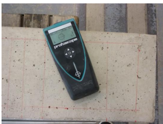
Obr. 1.14. Zakreslení polohy výztuže pomocí Profoscopy
