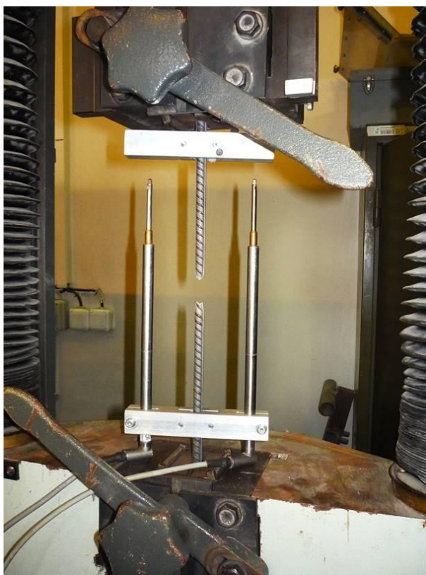
Obr. 1.13. Přetržení betonářské výztuže při zkoušce oceli v tahu
