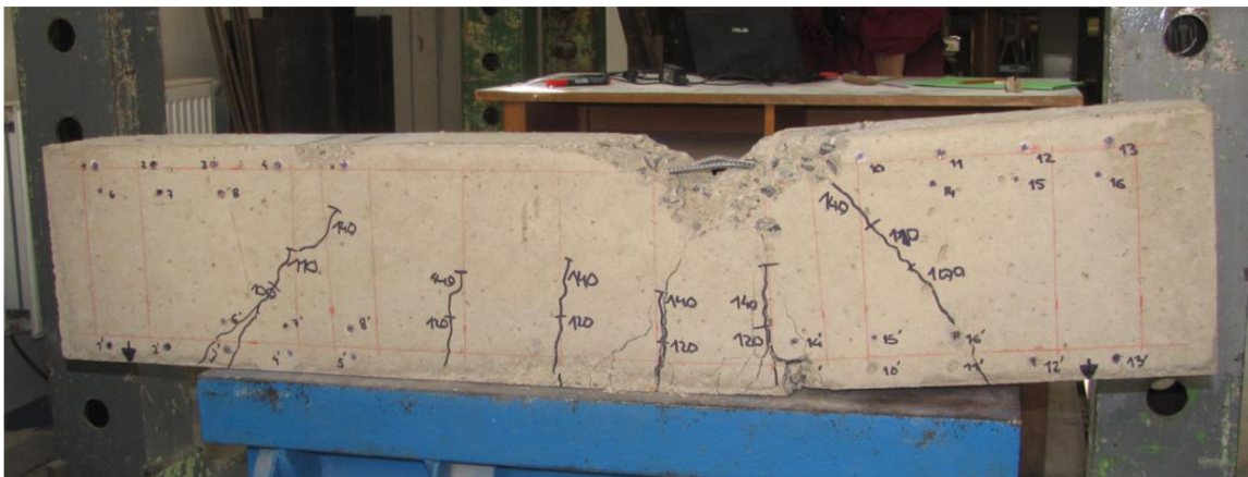
Obr. 1.23. Celkový pohled na vývoj trhlin při zatěžovací zkoušce
