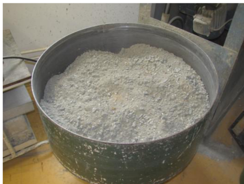
Obr. 1.7. Betonová směs v míchačce před dodáním záměsové vody
