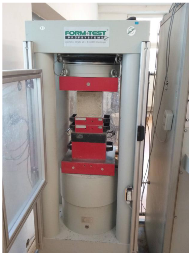
Obr. 1.11. Umístění zkušební tělesa do zkušebního lisu
