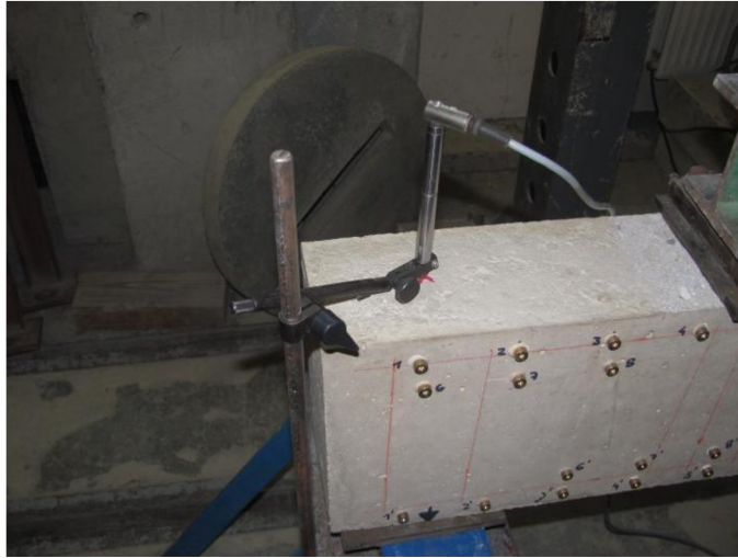
Obr. 1.18. Osazení indukčních snímačů nad podporou
