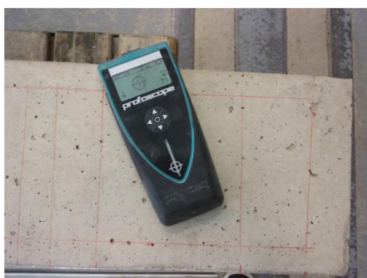
Obr. 1.14. Zakreslení polohy výztuže pomocí Profoscopy
