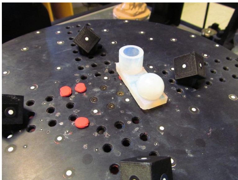
Obrázek 27 Ustavení vzorku na rotační stůl skeneru
