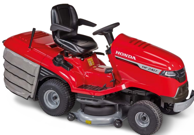
Obr. 5 Zahradní traktor Honda HF 2417 s výkonem 9,4 kW [5]
