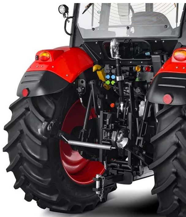
Obr. 15 Tříbodový závěs traktoru [10]
