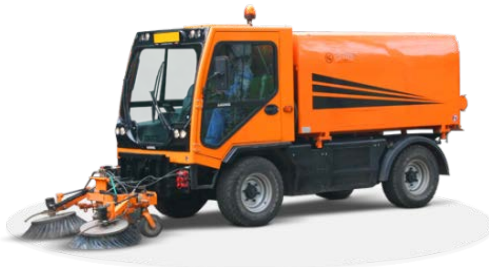
Obr. 7 Zametací stroj LADOG o celkové hmotnosti 7 t [6]
