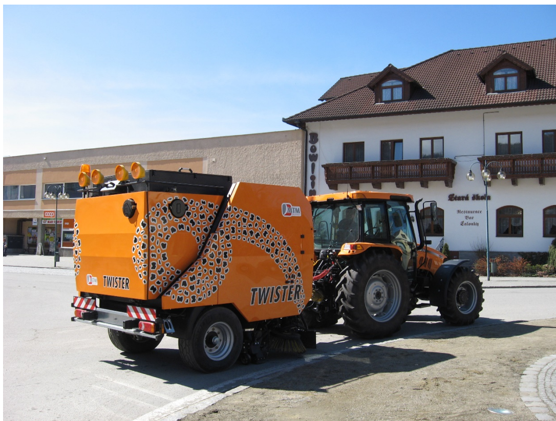
Obr. 8 Vlečený zametací stroj ZT 25 připojený za traktor CASE [2]
