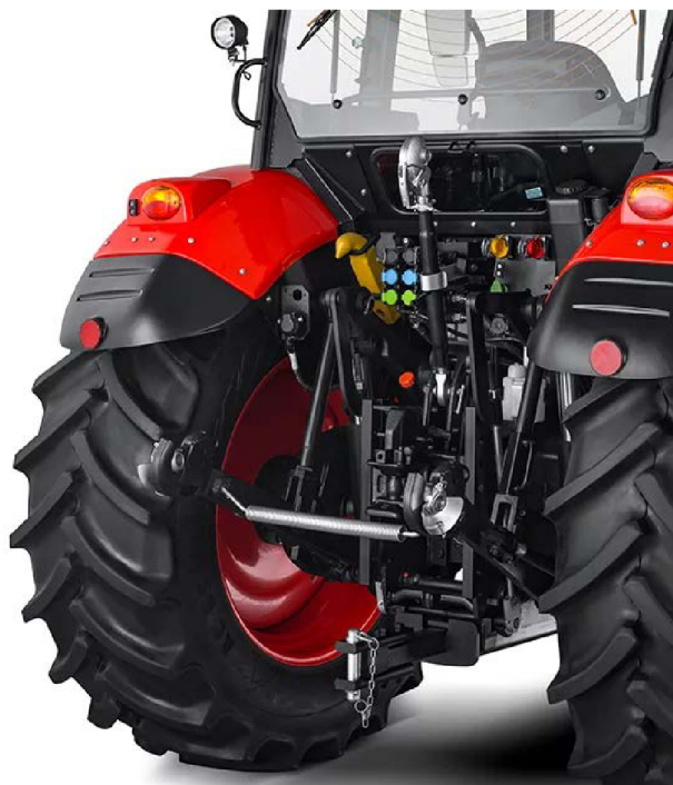
Obr. 15 Tříbodový závěs traktoru [10]
