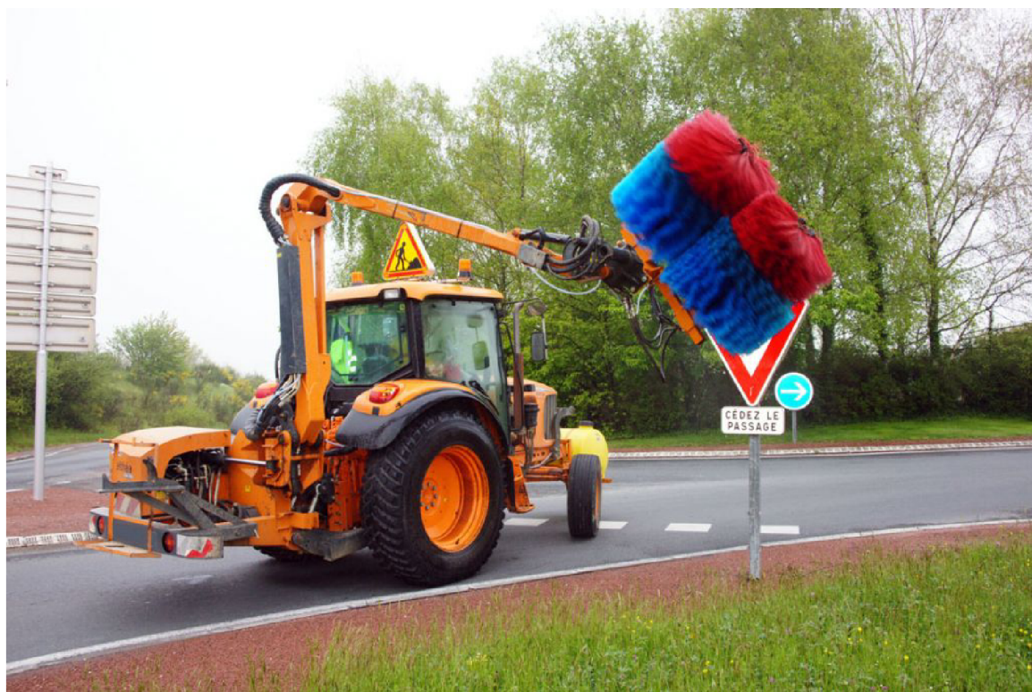
Obr. 1 Traktor při mytí svislé dopravní značky [1]
