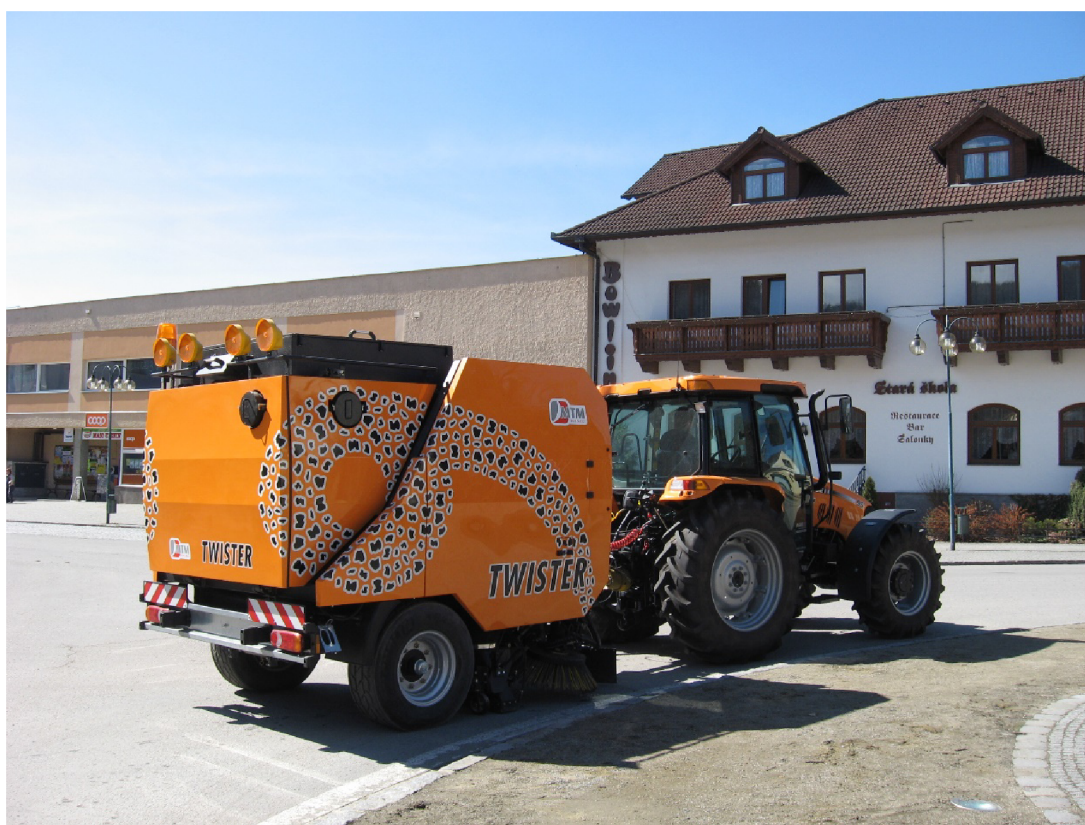
Obr. 8 Vlečený zametací stroj ZT 25 připojený za traktor CASE [2]
