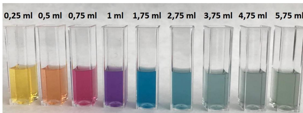
Obrázek 12 Výsledné zbarvení disperzí stříbra v závislosti na objemu přidaného citranu (množství citranu uvedené nad kyvetami)
