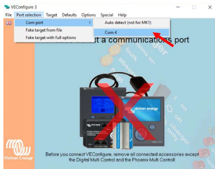
Obrázek 21 – Zvolení příslušného portu v programu VE.Configure 3 pro navázání spojení s PC [16]
