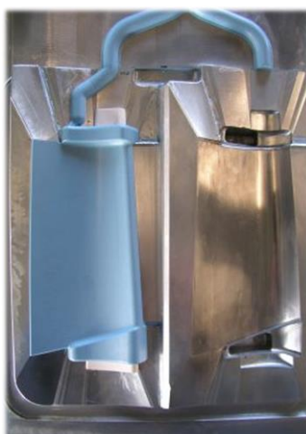
obr. 16 Voskový model s keramickým jádrem uvnitř vstříkovací formy [16]
