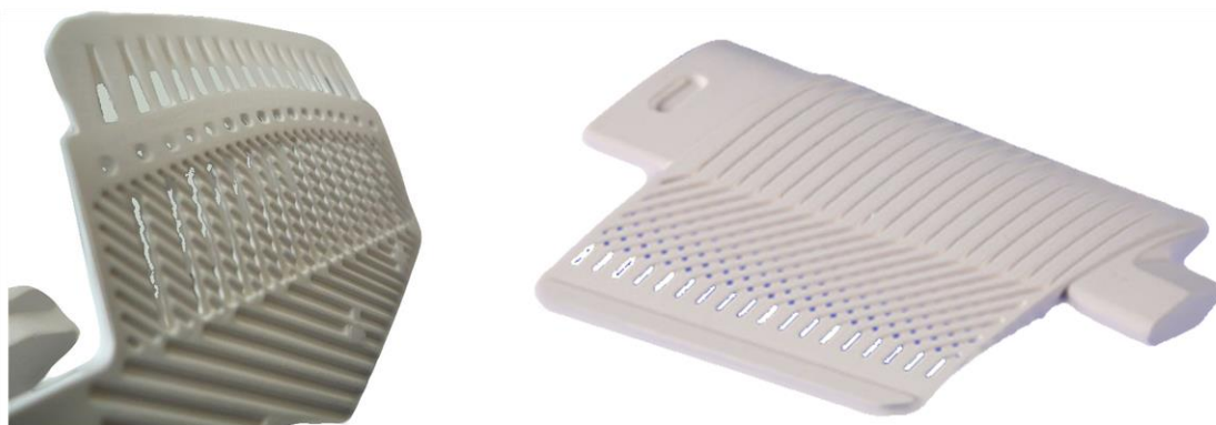
obr. 6 Keramické jádro pro chladící kanálky turbínových lopatek [10]
