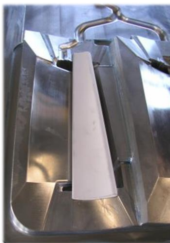
obr. 15 Keramické jádro uvnitř formy pro výrobu voskového modelu [16]
