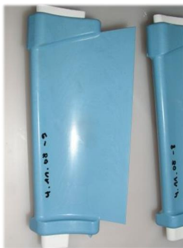
obr. 17 Hotový voskový model s keramickým jádrem [16]
