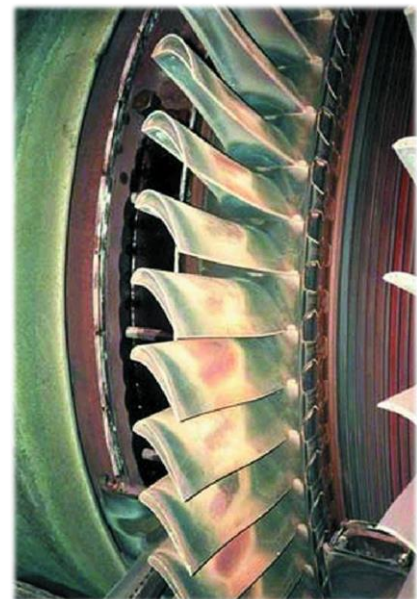
obr. 3 Turbína s viditelnou teplotní koncentrací [4]
