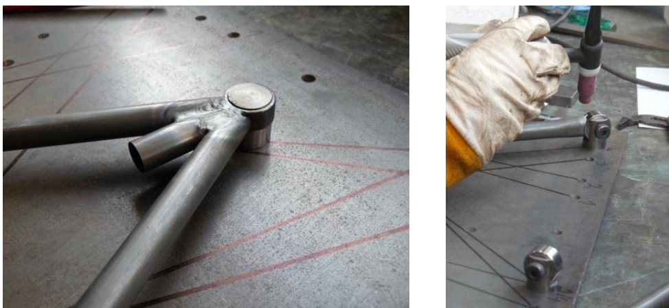
Obr. 42 Výroba lichoběžníkového ramena technologií svařování za pomoci vytvořených přípravků
