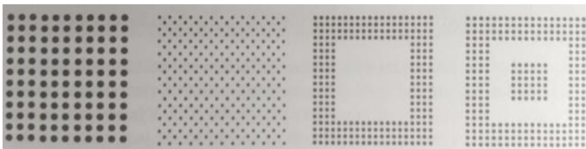
Obrázek 1.1: Rozmístění vývodů pouzder BGA [4]
