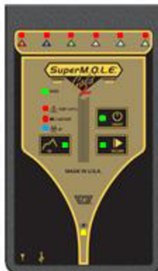
Obrázek 1.19: Použitý teplotní profiloměr se šesti kanály [17]
