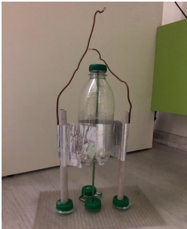
Obr. 25: Elektrostatický motor (vlastní tvorba)
