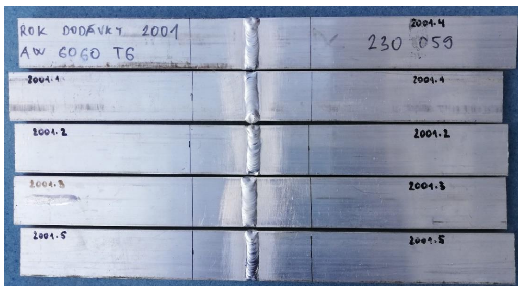
Obr. 39 Svařené vzorky sada 2001.
