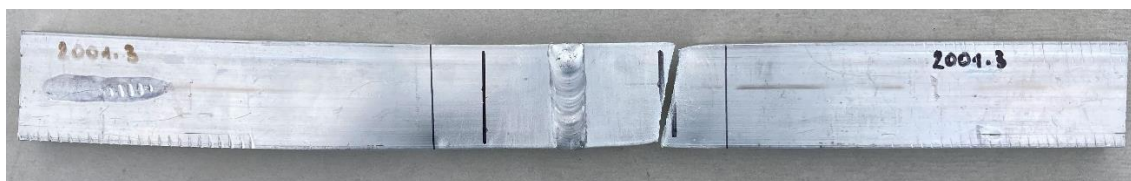
Vzorek 2001.3 po přetržení.
