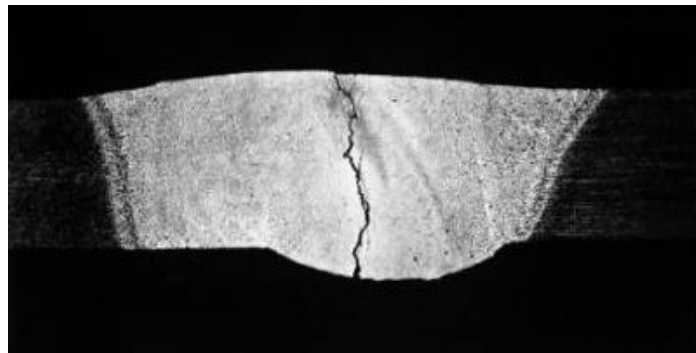
Obr. 24 Ukázka solidifikační trhliny ve svarovém kovu [36].
