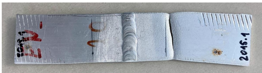
Vzorek 2015.1 po přetržení.
