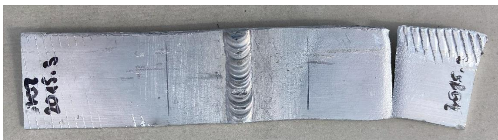
Vzorek 2015.3 po přetržení.
