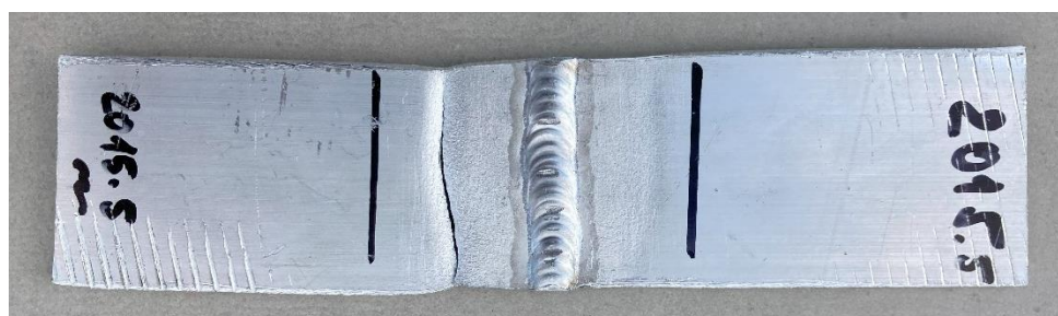
Vzorek 2015.5 po přetržení.
