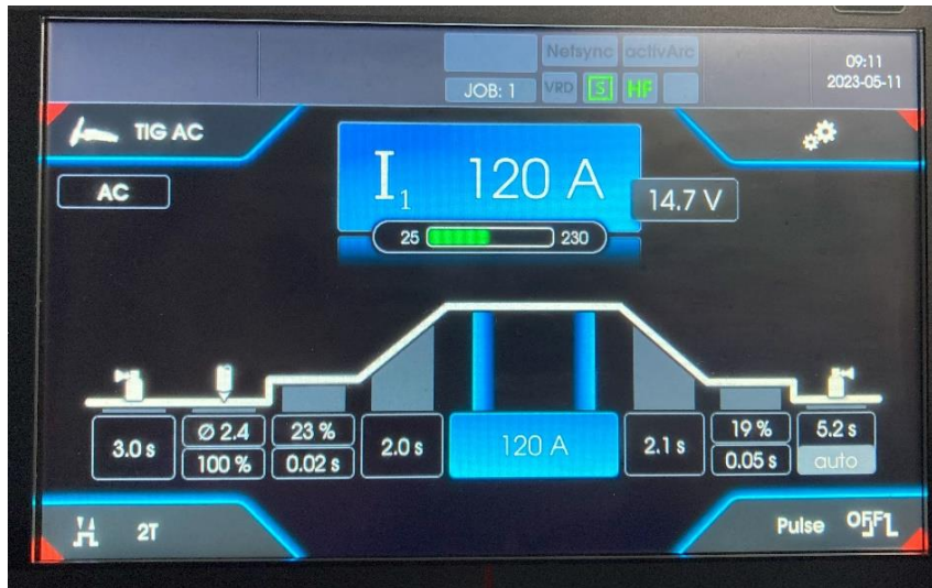
Obr. 43 Nastavení svařovacích parametrů na svářečce.
