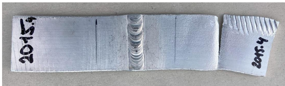
Vzorek 2015.4 po přetržení.
