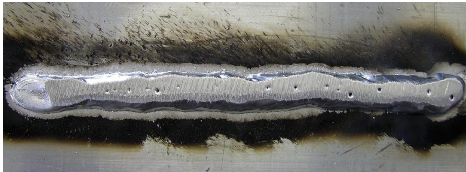
Obr. 22 Pórovitost svaru po obroušení povrchové vrstvy materiálu [34].
