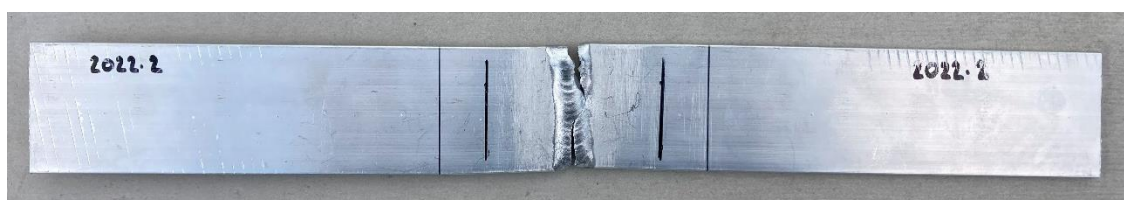
Vzorek 2022.2 po přetržení.
