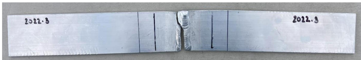
Vzorek 2022.3 po přetržení.
