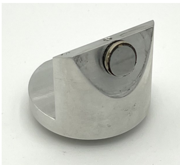
Obrázek 19 – Vzorek v přednakloněném držáku
